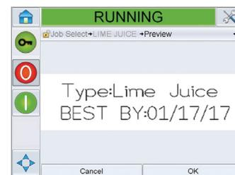
La previsualización del diseño de impresión permite confirmar que se ha cargado la tarea correcta y brinda a los operadores la seguridad de que se han introducido los datos pertinentes antes de realizar la impresión.
