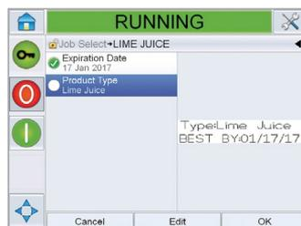
Según las reglas predefinidas durante la configuración de la tarea, solo se pueden editar los campos permitidos. La tarea de impresión solo se puede cargar después de que el operador haya confirmado cada introducción.
